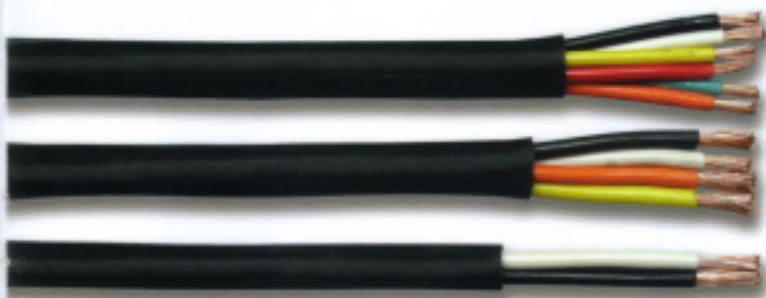
Estos conductores están fabricados con cobre electrolítico recocido al vacío, es decir, libre de oxígeno OFC forrado en su exterior por PVC de 90° y en su interior, cada conductor, con forro de 105° grados torcidos en haz y cada uno en diferente color, a fin de facilitar su clasificación de uso.
